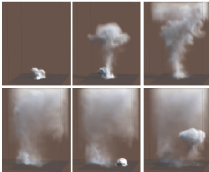
Abbildung 5.3: Ein Folge von einzelnen Zeitpunkten bei einer Rauchsimulation. Hier ist die Veränderung der Rauchsäule über die Zeit zu beachten. Diese Simulation wurde mit dem interaktiven Hardware-basierten Renderer berechnet.
